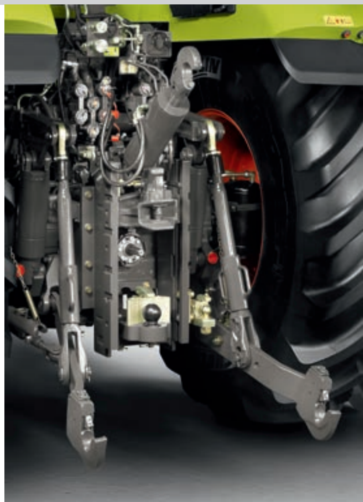
Внешние элементы управления для задней навески, ВОМ и секция гидрораспределителя на выбор
