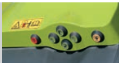
Внешние элементы управления для задней навески, ВОМ и секция гидрораспределителя на выбор
