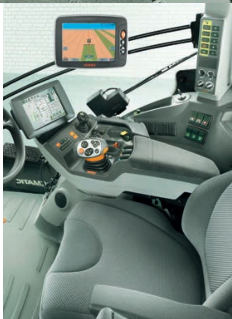
Панель управления (11) в подлокотнике: полный привод, блокировка дифференциала, автоматика вала отбора мощности и подвеска переднего моста
